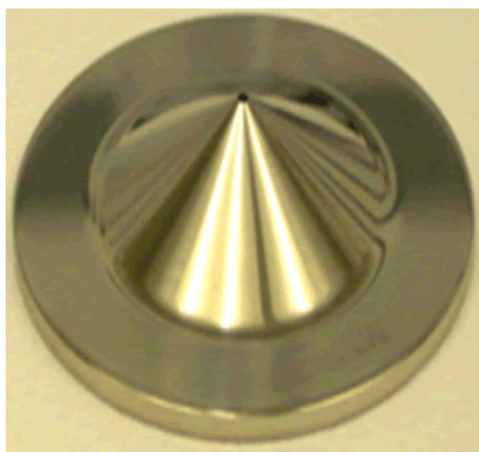
Рис. 5. Схематическое изображение интерфейсной части ИСП-МС в разрезе (а) и фотография пробоотборного конуса (б) масс-спектрометра с индуктивно связанной плазмой XSeries 2 (ThermoFisher Scientific).
