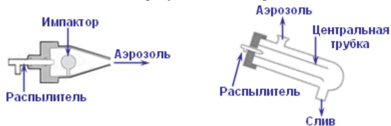
Рис. 2. Схематическое изображение (а) двухходовой распылительной камеры и (б) одноходовой камеры с шариком-импактором.
